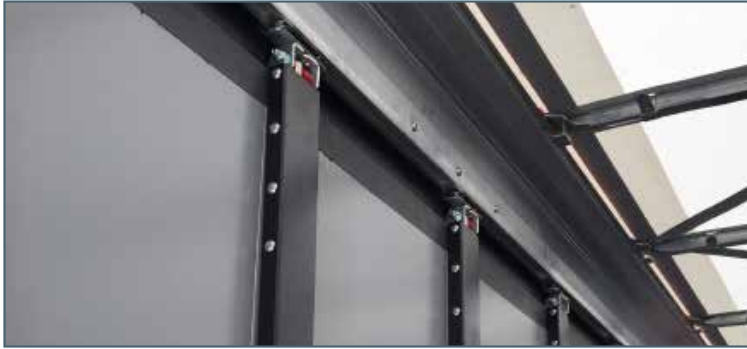
Rail de guidage supérieur intégré dans la sangle de toit
