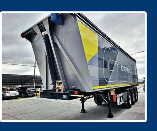
Sa forme courbée a été conçue pour diminuer la consommation du tracteur et des émissions de CO2, ce qui permet également de réduire l'empreinte carbone.
